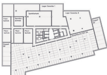
2. Untergeschoss 1:500 Abstellräume, Lager Gewerbe, Technik
